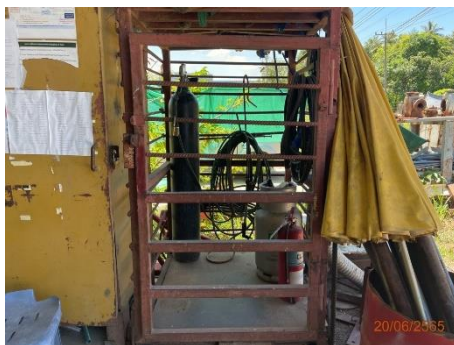
ภาพที่ 2.2-50 การวางถังแก๊สในแนวตั้ง
