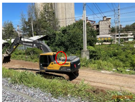
ภาพที่ 2.2-44 สัญญาณไฟขณะเครื่องจักรปฏิบัติงาน
